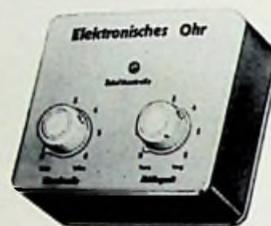
Sprachgesteuerter Schalter für Tonbandgeräte 6-9 V/0,3 A, eingebautes Mikrofon, regelbarer Empfindlichkeit und Abschaltverzögerung (anzuschließen an Fernbedienungsbuchse oder in Batterieleitung) zur Aufzeichnung von Diktaten, Besuchergesprächen, Ereignissen in Räumen.
